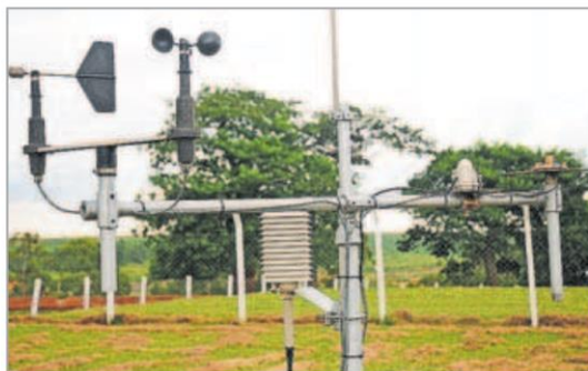
Detalhe da estação automática, que não precisa de observador
