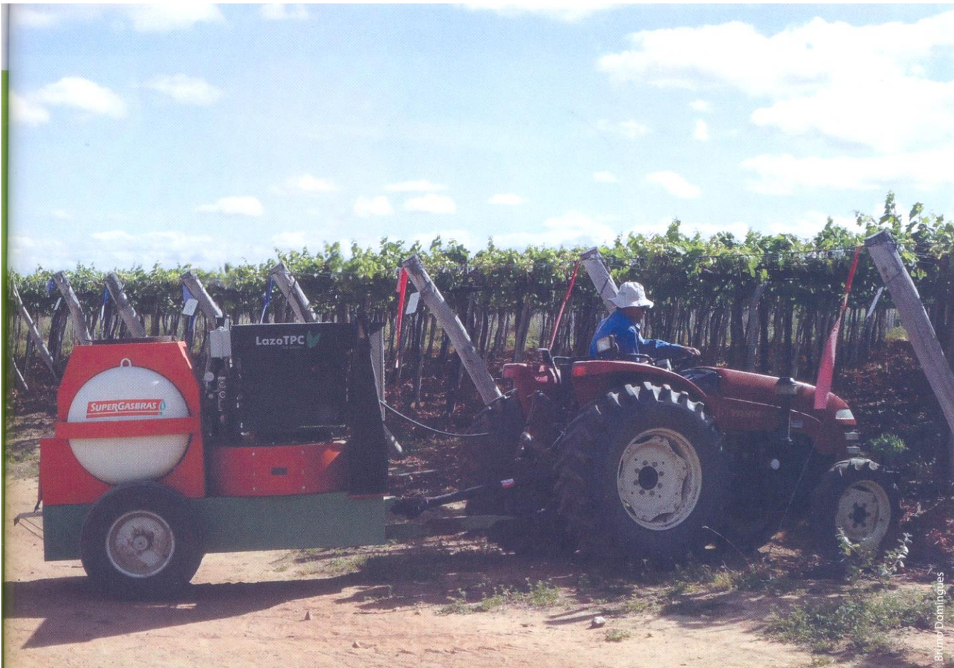
Máquina TPC aplicando estresse térmico nos parreirais de uva da variedade Festival em campo experimental em Petrolina
