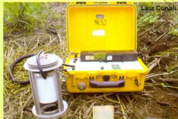
Câmara utilizada na avaliação do fluxo de CO<sub>2</sub>
