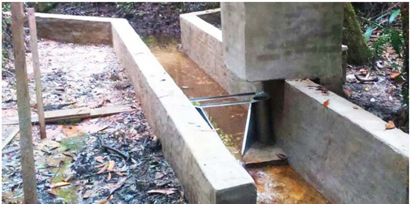
Calha da microbacia na Estação Itatinga para medir o nível de água – Foto: Reprodução / Esalq
