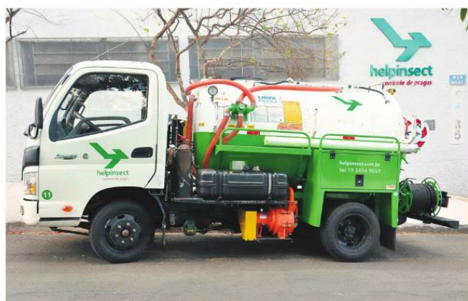
Caminhão combinado para limpeza de caixas de gordura e tubulações em geral
