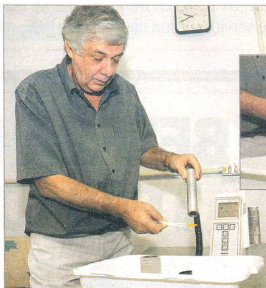
Professor Virgílio mostra aparelho medidor de radiação em uma fonte beta (detalhe acima) que é utilizada nas aulas práticas no Cena
