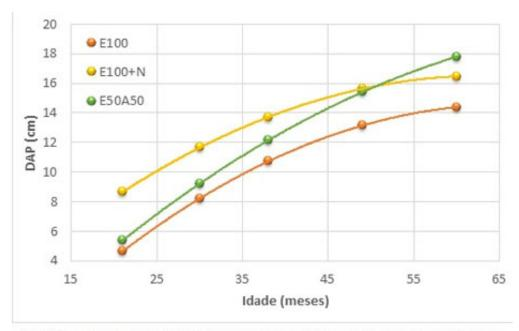
O gráfico mostra a evolução do diâmetro médio de árvores de eucalipto ao longo de 60 meses de crescimento em sistema de monocultivo com (E100 +N) e sem adubação nitrogenada (E100), e em consórcio com a Acacia mangium (E50A50).
