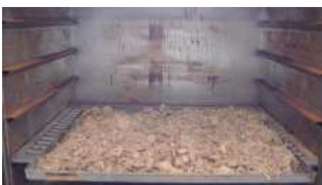
Biomassa de bagaço de cana-de-açúcar passa por processo de secagem em estufa
