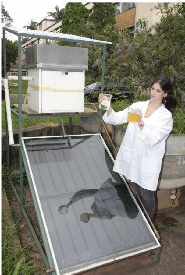
O protótipo é capaz de destilar até 3,3 litros de água ao dia e atende à demanda na área de Química da Esalq
