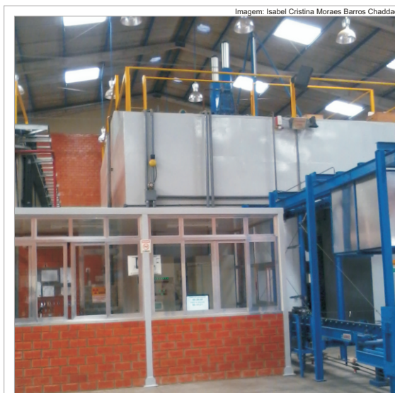
Irradiador Multipropósito de Cobalto-60
