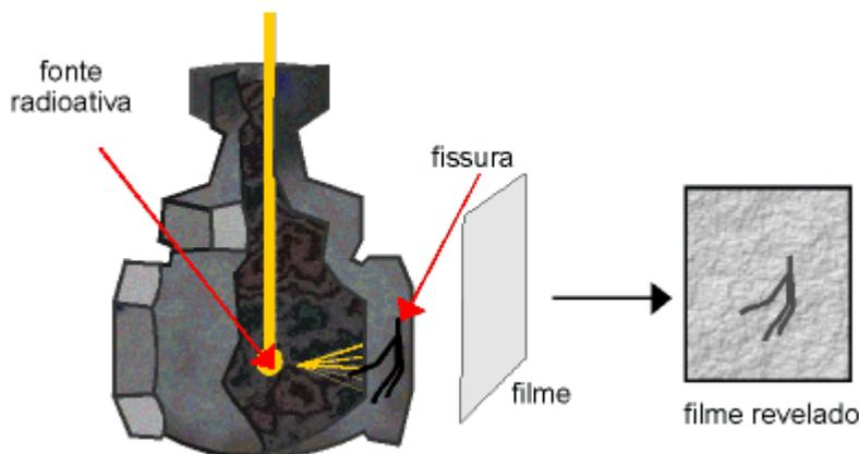
As empresas de aviação fazem inspeções freqüentes nos aviões, para verificar se há “fadiga” nas partes metálicas e soldas essenciais sujeitas a maior esforço (por exemplo, nas asas e nas turbinas) usando a gamagrafia.
