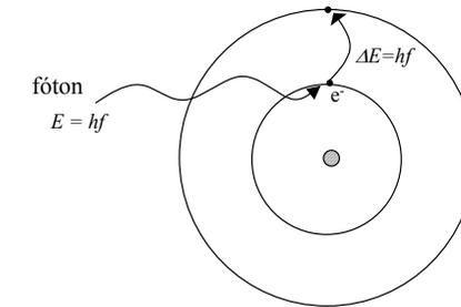
Figura 3.1- A incidência de um fóton num elétron pode causar a sua excitação com a consequente absorção do fóton.
