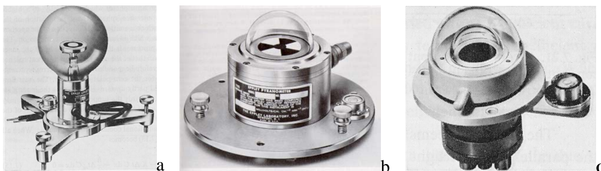
Figura 5.5. Piranômetros de termopar, modelo Eppley (a e b), e de Moll-Gorczyński (c).
