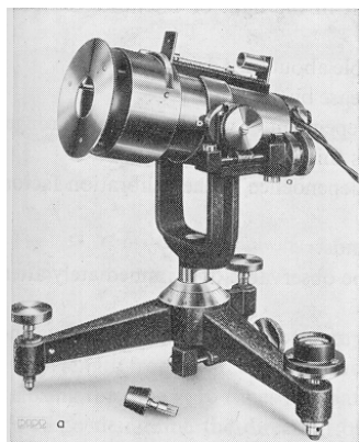
Figura 5.7. Sensores de radiação solar: a) direta; b) banda metálica para obtenção da radiação solar difusa.
