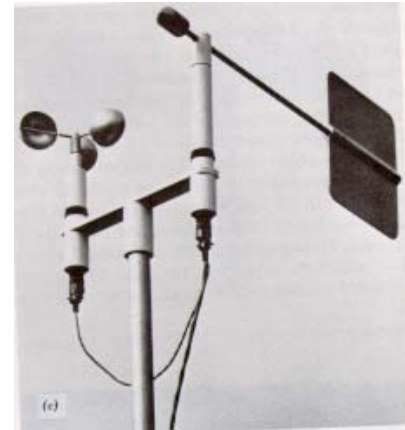
Figura 9.1. Anemógrafo utilizado em estações meteorológicas automáticas.
