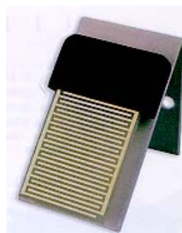
Figura 7.5. Sensor automático utilizado para a medida do orvalho e de sua duração.
