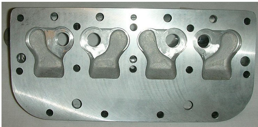
Figura 5 – Câmaras de compressão presentes no cabeçote.
