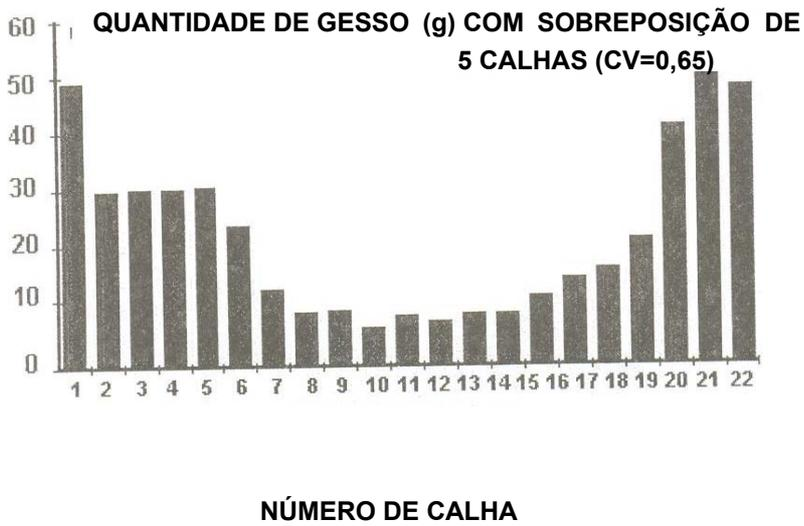
Figura 13. Faixa de deposição com 5 calhas sobrepostas.
