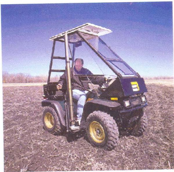
**Figura 16. Veículo amostrador de solos equipado com DGPS (pg. 41)**
