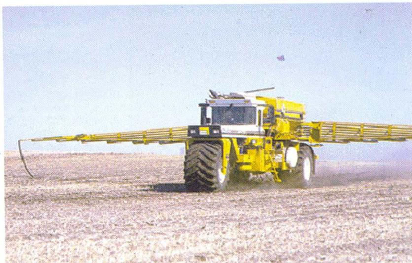
Figura 18. Equipamento para aplicação localizada de insumos (pg.43)
