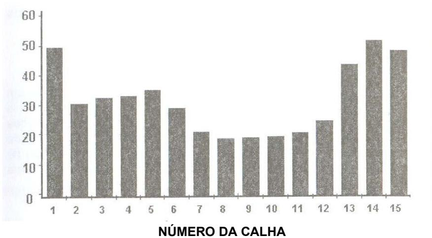
Figura 14. Faixa de deposição com 11 calhas sobrepostas.
