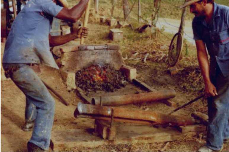
Fotografia 3 – Apontamento de broca, aquecida em forja e apontada a golpes de marreta.
