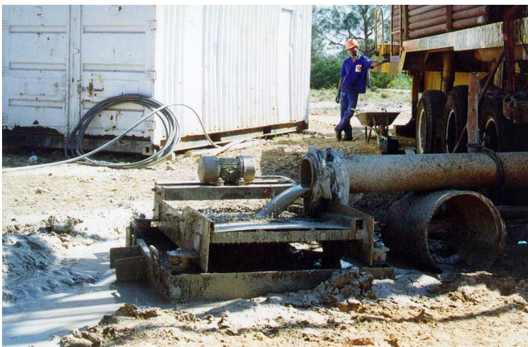
Fotografia12- Peneira vibratória de sonda rotativa.
