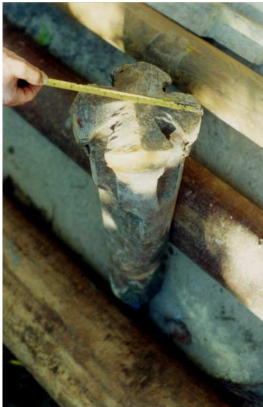
Fotografia 2- Detalhe de broca de alargamento tipo estrela.
