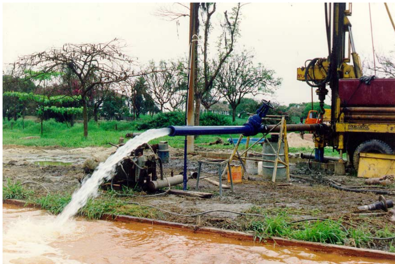
Fotografia 20- Aspecto do ensaio de bombeamento escalonado com bomba submersa e tubo de Pitot executado para Usina do Queimado, em CAMPOS, vazão de 230 m 3 /h.
