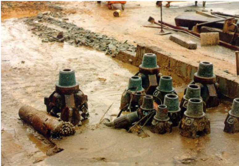
Fotografia 9 - Brocas tri-cônicas e de vídia utilizadas por sonda rotativa.
