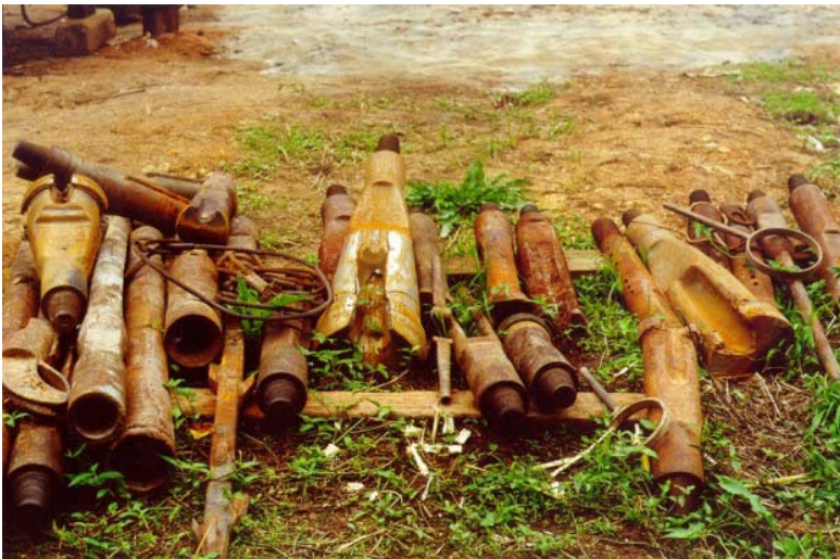
Fotografia 4 - Tipos de brocas e ferramentas de pescaria utilizadas para perfuração de diversos tipos litológicos, a partir de 14 polegadas.
