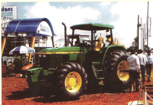
Fig. 10 - Estrutura de proteção contra capotamento de 4 pontos
