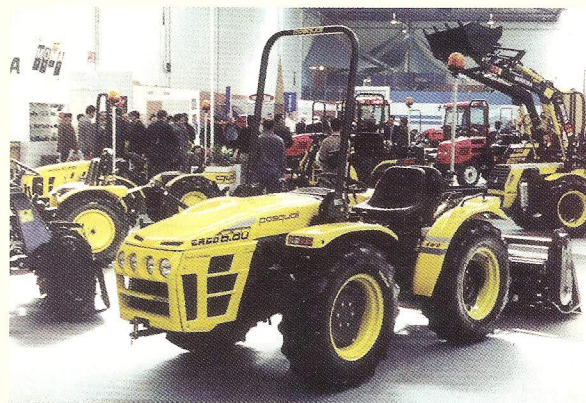
Fig. 11 - Estrutura de proteção contra capotamento do tipo arco de proteção
