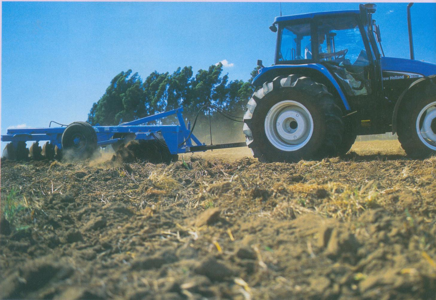
“A escolha de um pneu adequado para as rodas motrizes de um trator agrícola não deve limitar-se simplesmente no fato de que ele tem que suportar carga vertical, transmitir potência e produzir força de tração”
