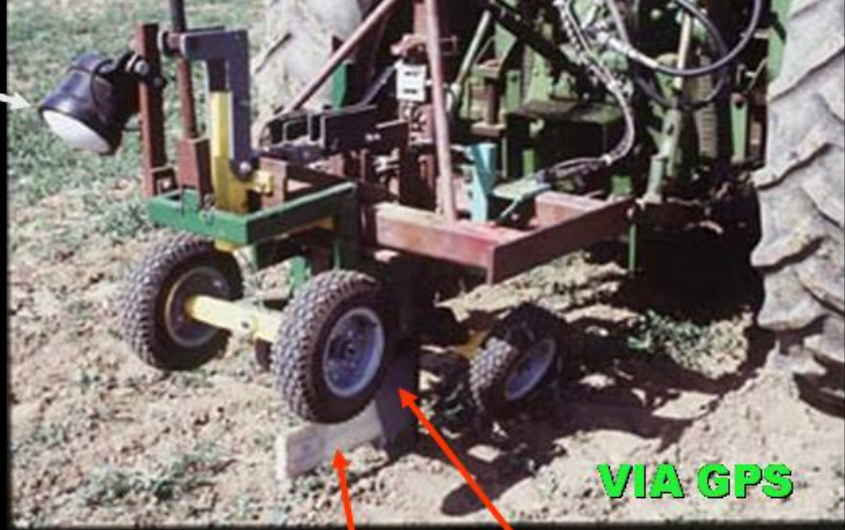
SENSORES DE HUMIDADE
