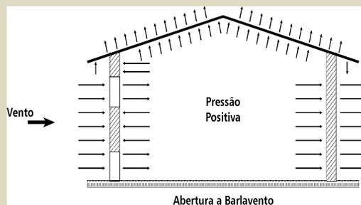
Figura 6. Efeitos do tipo de fluxo e pressão do vento em função da localização das aberturas em estruturas agrícolas
