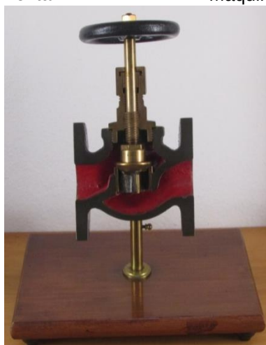
Válvula de vapor
