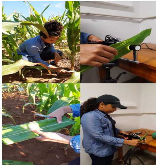
Leituras hiperespectrais foliar do milho através do sensor espectrorradiômetro ASD FieldSpec FR Spectroradiometer® (ASD – Analytical Spectral Devices Inc., Boulder, CO, EUA);
