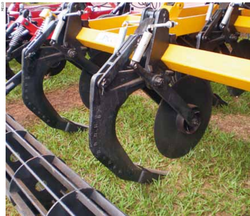
FIGURA 7 | DETALHE DA HASTE E MOLAS HELICOIDAIS
