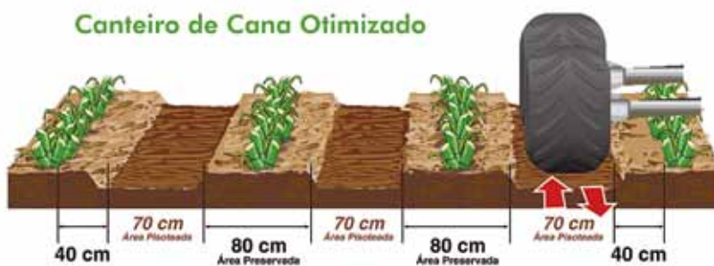
FIGURA 8 | CONTROLE DE TRÁFEGO NA COLHEITA MECÂNICA E “CANTEIRIZAÇÃO” DAS LINHAS DE CANA
