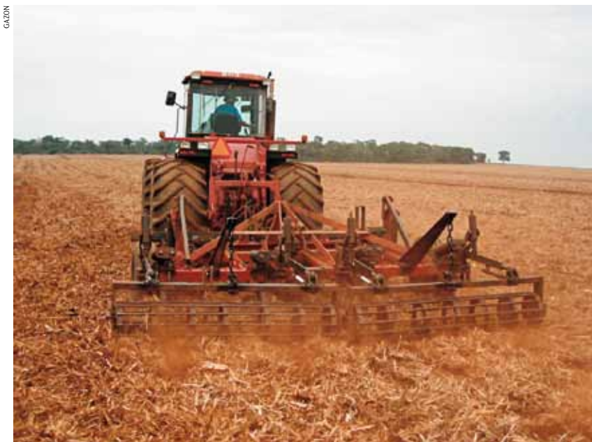
FIGURA 6 | OPERAÇÃO DE PREPARO DE SOLO COM O SUBSOLADOR/DESTORROADOR
