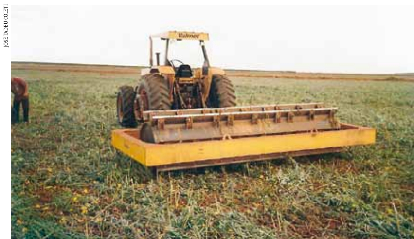
FIGURA 13 | ROLO-FACA: EQUIPAMENTO IMPORTANTE NA CONCLUSÃO DO SPM EM ÁREA DE CROTALÁRIA JUNCEA
