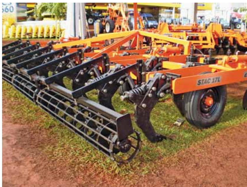
FIGURA 5 | EQUIPAMENTO CHAVE PARA O SPM : SUBSOLADOR COM HASTES PARABÓLICAS, DISCOS FRONTAIS DE PALHA E ROLO TRASEIRO PARA NIVELAMENTO DO SOLO
