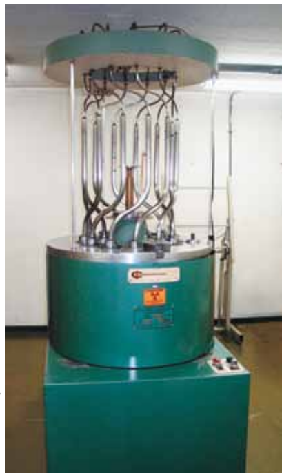
FIGURA 3 | IRRADIADOR GAMA DE COBALTO-60, UTILIZADO PARA ESTERILIZAÇÃO DE MOSCAS-DAS-FRUTAS; USP/CENA, PIRACICABA, SP.
