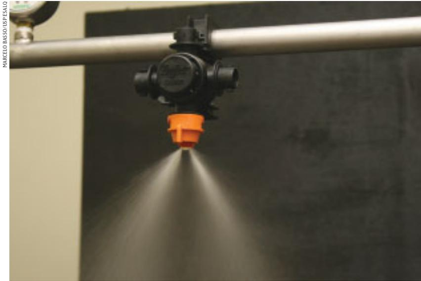
FIGURA 3 | BARRA DE PULVERIZAÇÃO COM UM MODELO DE CORPO DE BICO DE PULVERIZAÇÃO DE DUPLO JATO
