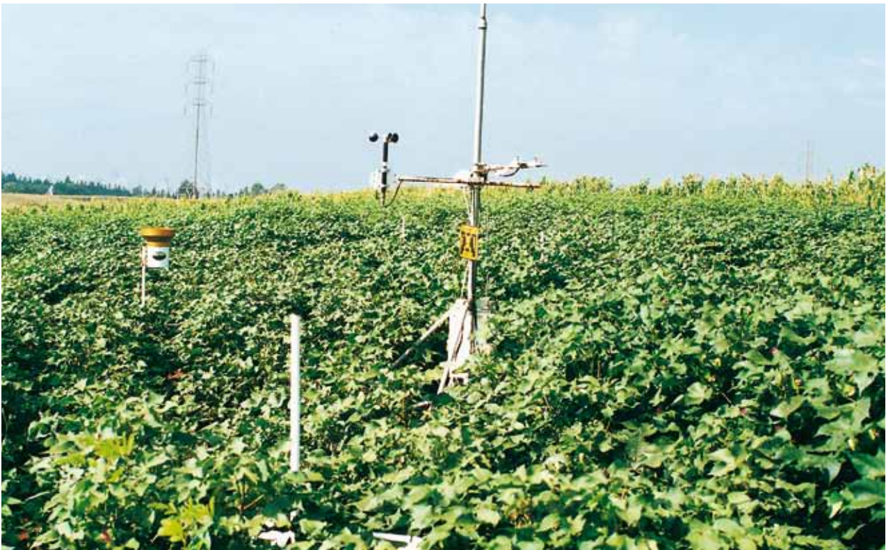
Estação meteorológica automática em experimento com algodoeiro
