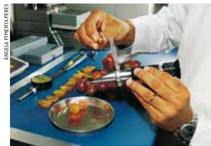
FIGURA 2 | PROCEDIMENTO PARA DETERMINAÇÃO DO TEOR DE SÓLIDOS SOLÚVEIS (°BRIX) DA UVA FINA DE MESA, CONFORME A IN SARC N. 2/2002.
