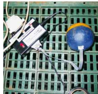
FIGURA 3 | ESFERA INSTRUMENTADA UTILIZADA NA AVALIAÇÃO DO IMPACTO DE LINHAS DE BENEFICIAMENTO DE PÊSSEGOS (A) E TRANSFERÊNCIA DE DADOS PARA O COMPUTADOR (B)
