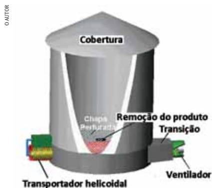
FIGURA 2 | ESQUEMA BÁSICO DA SECAGEM EM SILO, MOSTRANDO A FRENTE DE SECAGEM
