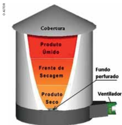
FIGURA 2 | ESQUEMA BÁSICO DA SECAGEM EM SILO, MOSTRANDO A FRENTE DE SECAGEM
