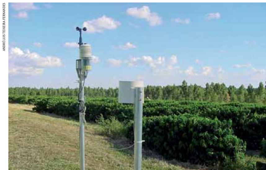
FIGURA 6 | ESTAÇÃO AUTOMÁTICA INSTALADA PRÓXIMO À LAVOURA DE CAFÉ
