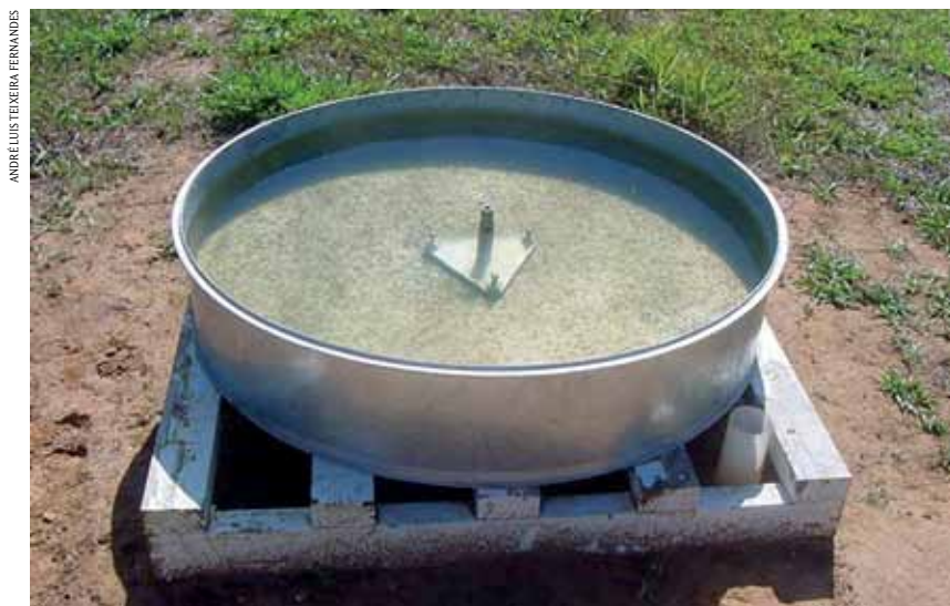
FIGURA 7 | TANQUE DE EVAPORAÇÃO “CLASSE A”
