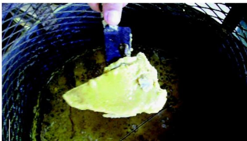
Figura 9 - Cera em processo de solidificação após passar pela rede de contenção dos resíduos
