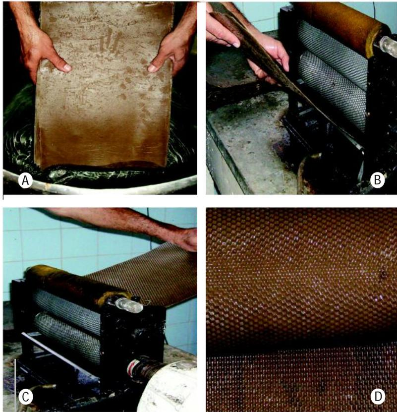
Figura 16 - Processo de alveolamento de cera apícola utilizando cilindro. A. lâminas de cera sendo molhadas para separar uma das outras; B. introdução da lâmina no alveolador para estampagem; C. lâmina de cera sendo retirada do alveolador; D. lâmina de cera com alvéolos de operária estampados
