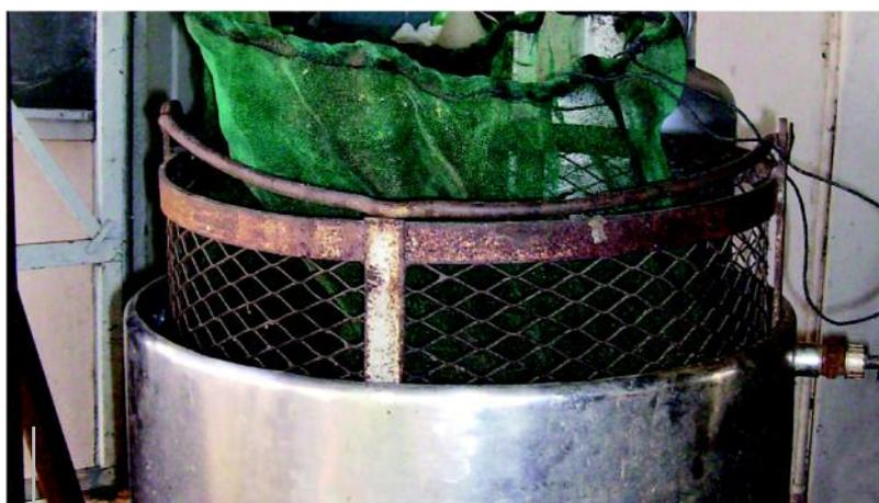
Figura 8 - Recipiente de aço inox e saco de rede utilizados para extração de cera
