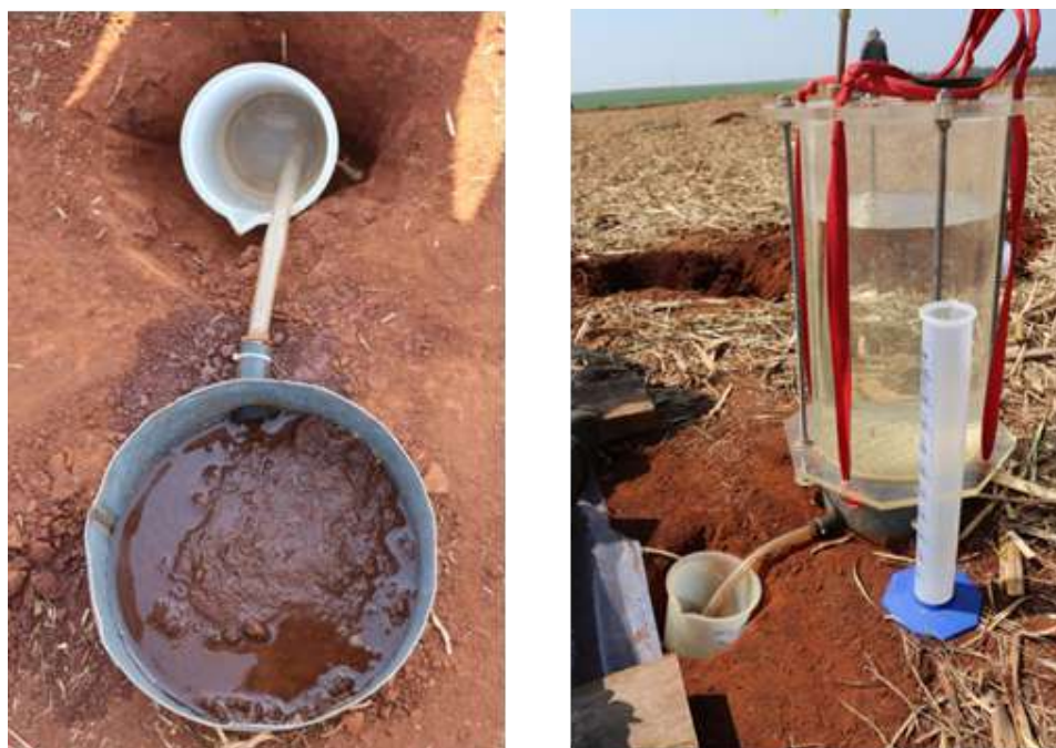
Figura 3. Metodologia para determinação da taxa de infiltração e escoamento superficial em solo utilizando um infiltrômetro de Cornell (van Es e Schindelbeck, 2003)
