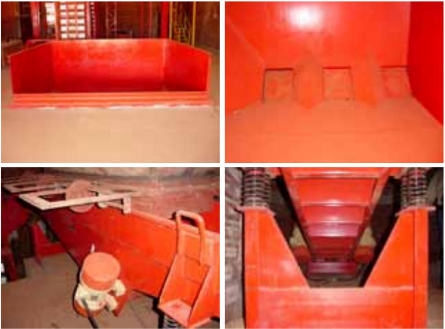
**Figura 16.** a) Caixa de recepção da moega vibratória. b) Fundo do cone metálico. c) Calha vibratória detalhe do sistema de vibração. d) Calha vibratória detalhe do sistema de molas.
