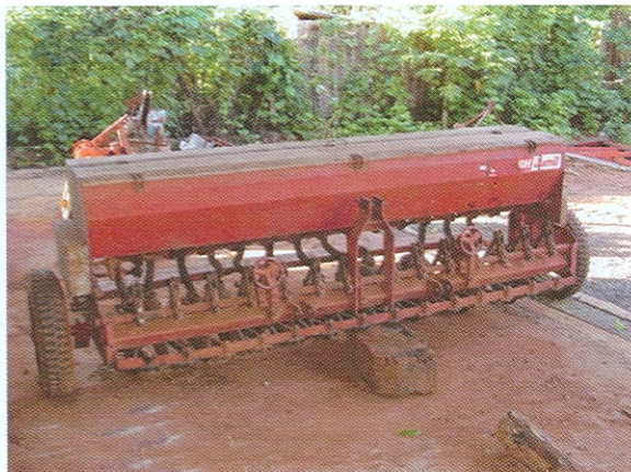
Figura 15 - Engate de 3 pontos (vista de frente). O implemento ocupa uma largura de trabalho de 2,40 m, e pode ser trabalhado a uma velocidade de até 7km/h
