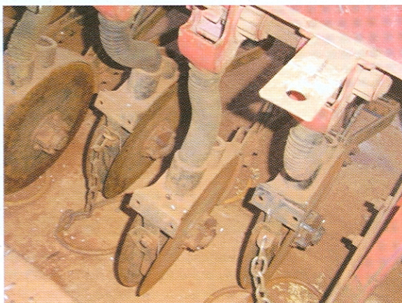
Figura 16 - Detalhe de mecanismos dosador e distribuidor, e da corrente que para "espalhar" terra por cima
