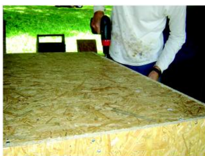
Figura 19 - Parafusando o fundo da caixa nas laterais
