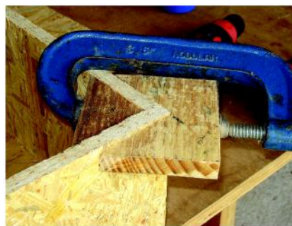
Figura 10 - Usando o encaixe para quinas
