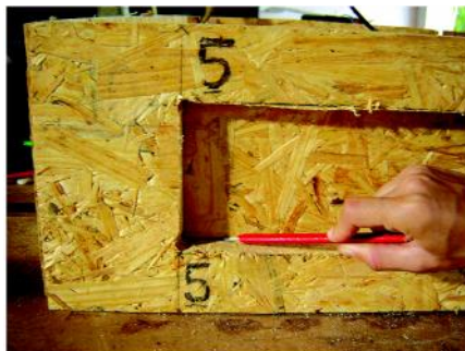
Figura 13 - Marcação da abertura de ventilação nas peças laterais interiores
