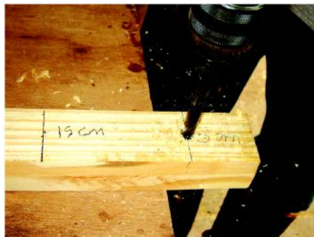
Figura 36 - Perfuração dos suportes inferiores do secador
