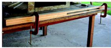
Figura 30 - Colagem do suporte superior do secador
