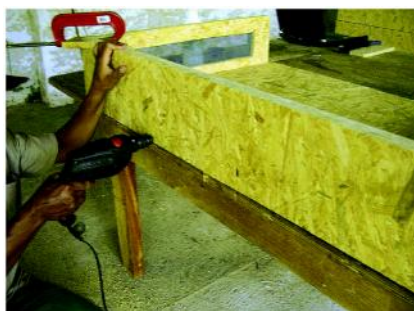
Figura 18 - Parafusando a lateral do secador sem abertura de ventilação
