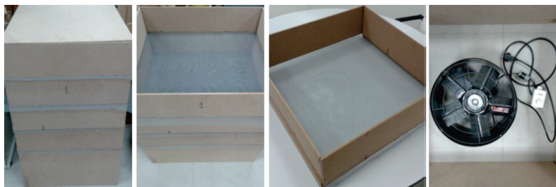
Figura 29 - Caixas para a secagem de lúpulo a frio por exaustão
