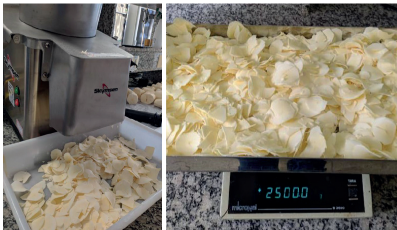
Figura 6 - Fatiador mecânico para formar as raspas de mandioca e pesagem antes da desidratação Fonte: GEFH
