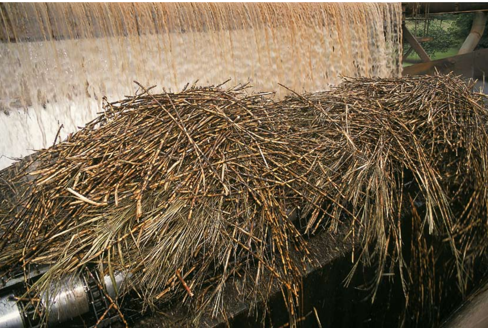
Lavagem de cana-de-açúcar na alimentação de esteira na Usina da Barra; Barra Bonita, SP; 2001
