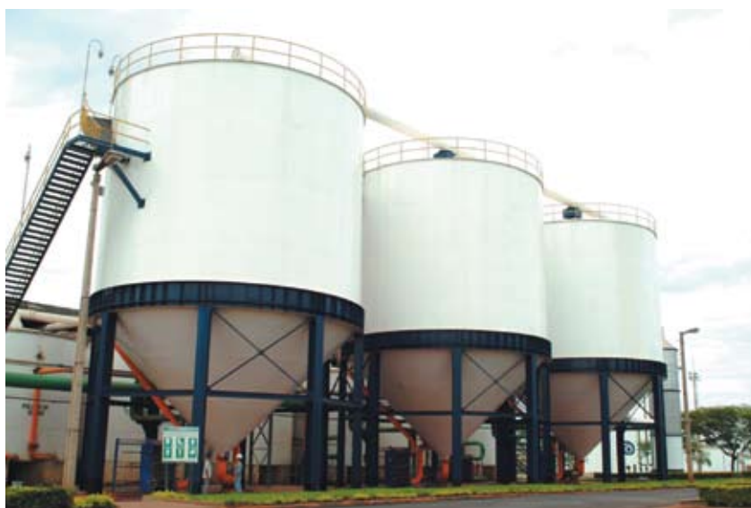
FIGURA 2 | DETALHE DAS DORNAS DE FUNDO CÔNICO: MELHOR DESEMPENHO OPERACIONAL. CRÉDITOS: FERMENTEC
