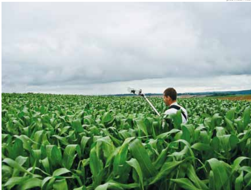
FIGURA 3 | UTILIZAÇÃO EXPERIMENTAL DE SENSOR ÓTICO ATIVO, 2008*
