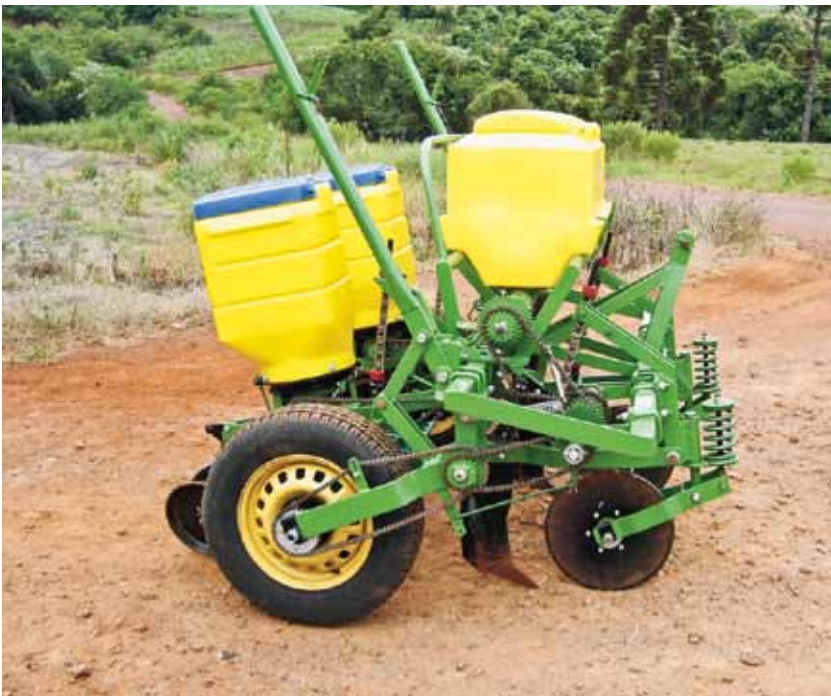
Máquina leve para semeadura em SPD
