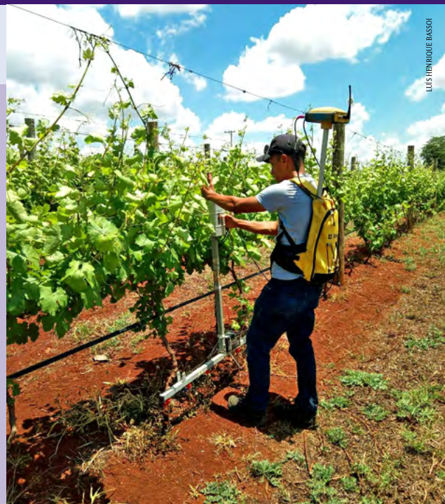
Técnico mede condutividade elétrica aparente de solo com equipamento portátil desenvolvido pela Embrapa; instrumentação tem GPS acoplado ao equipamento; São Carlos, SP, s.d.
