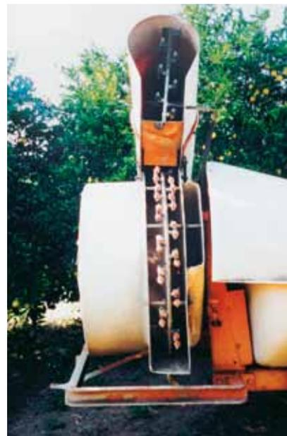
**FIGURA 2 | RAMAL ESPECIAL DE PULVERIZAÇÃO DE UM TURBOPULVERIZADOR, COM MAIOR NÚMERO DE BICOS**
