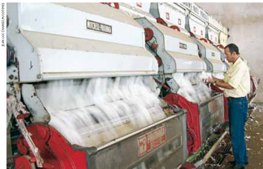
FIGURA 5 | CONJUNTO DE DESCAROÇADORES
