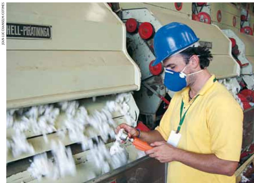
FIGURA 4 | MEDIÇÃO DA UMIDADE DO ALGODÃO EM CAROÇO NA ENTRADA DO DESCAROÇADOR
