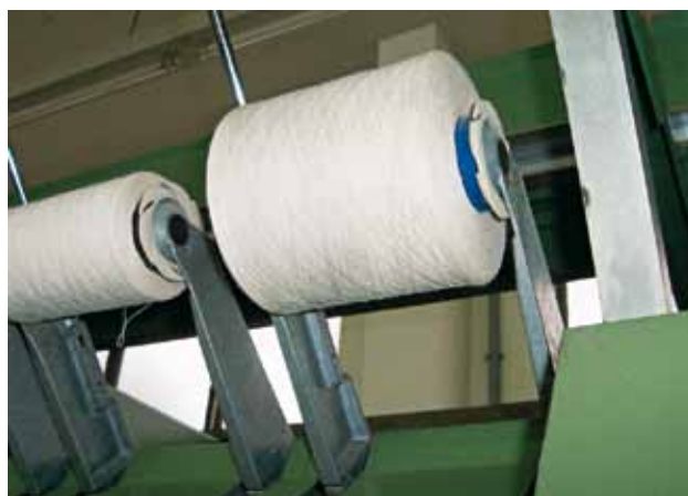
FIGURA 2 | BOBINA DE FIO PRODUZIDA EM FILATÓRIO A ROTOR
