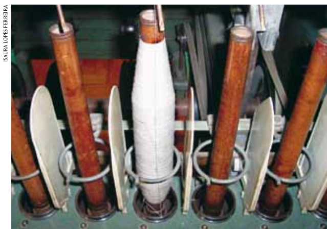
FIGURA 1 | ESPULA DE FIO PRODUZIDA EM FILATÓRIO A ANEL
