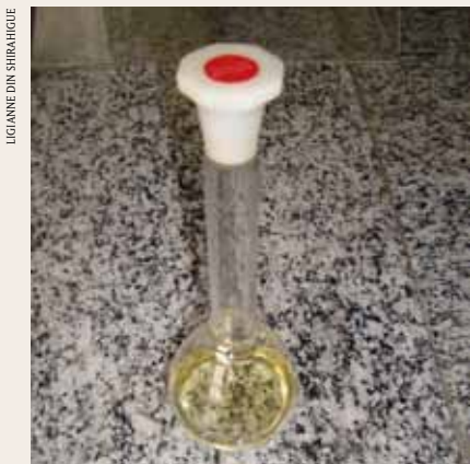
FIGURA 1 | OLÉO DE TILÁPIA OBTIDO POR CENTRIFUGAÇÃO APÓS FRACIONAMENTO DA SILAGEM DE PESCADO; PIRACICABA, SP, 2011
